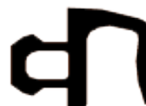
Sezione della guarnizione di battuta del telaio
