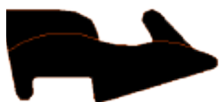
Sezione della guarnizione per la vetratura
