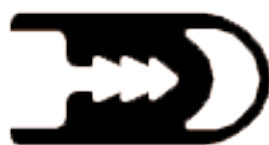
Sezione della guarnizione centrale di tenuta
